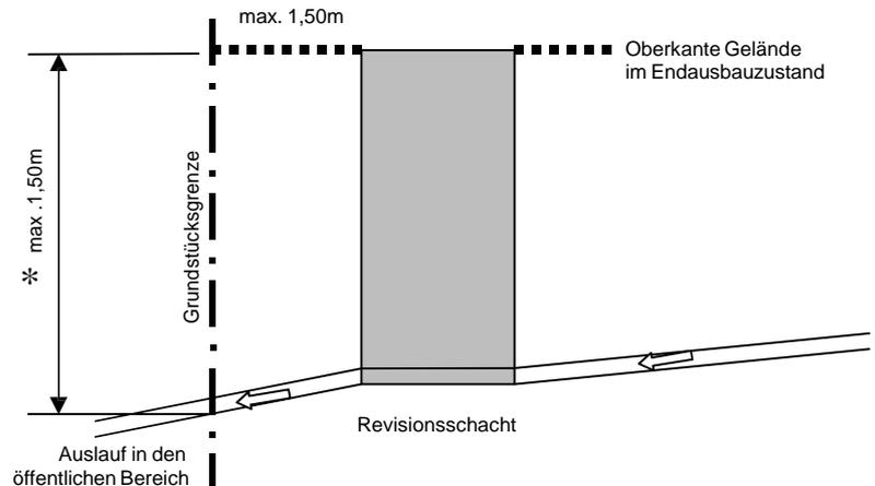
**\*Neue Anschlussleitungen** werden vom Abwasserbetrieb Troisdorf AöR in einer **Tiefe von 1,20m bis 1,50m** an der Grundstücksgrenze hergestellt. Sollte im Ausnahmefall eine andere Tiefe notwendig sein, kann diese schriftlich, mit Angabe der gewünschten Höhe und Begründung, separat beim Abwasserbetrieb beantragt werden. Der Abwasserbetrieb prüft dann, ob eine tiefe Herstellung des Anschlusses möglich ist.
